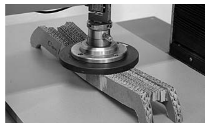
Die Siegbrücke der Elfklässlerin Clara Lapp wog nur 83 g und hielt dennoch einer Maximalbelastung von 12,9 kg stand.
