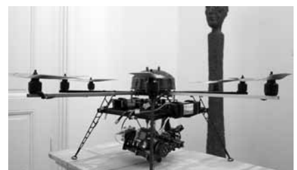
Der Octocopter mit eingebauter Thermografiekamera und einem leistungsstarken Rechner.
